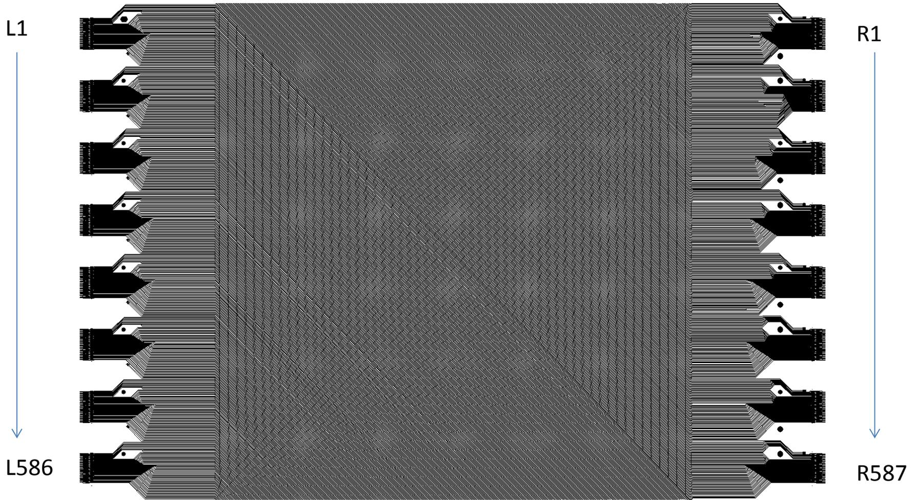
Nel lato sx l'ultimo connettore ha una connessione in meno per le V
